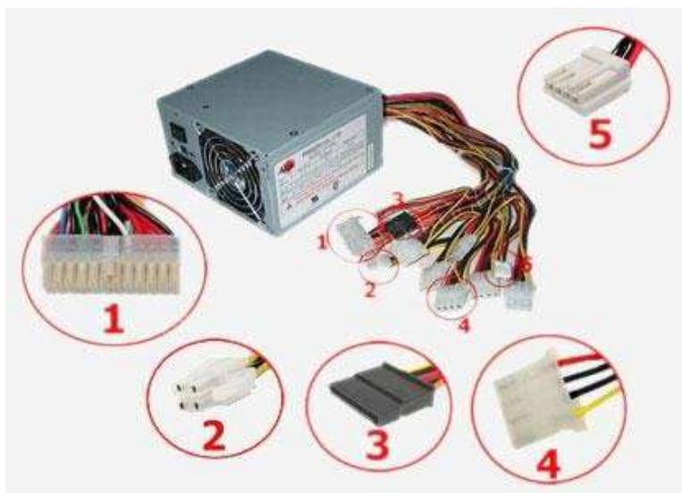
1 - 24-х контактный модуль питания, который подключается непосредственно к материнской плате и подает по разным линиям проводов на нее напряжения, в 5, 3 и 12 вольт, необходимые для функционирования различных устройств компьютера.
