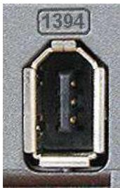
Это порт, в ближайшее время, может появиться на многих моделях проекторов, хотя сегодня он имеется пока только на некоторых профессиональных. IEEE-1394 (торговая марка компании Apple) используется, например, в цифровых видеокамерах mini-DV. Передача сигнала в проектор непосредственно в цифровом виде также будет обеспечивать очень высокое качество изображения.
