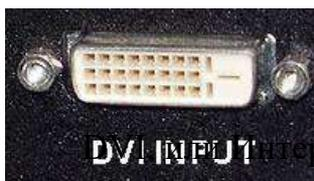
Интерфейс Цифрового Видео (Digital Visual Interface), является относительно новым для передачи графического сигнала. Он был разработан, как альтернатива RGB, для связи источников сигнала с отображающими устройствами. Этот интерфейс использует полностью цифровой стандарт передачи данных, благодаря которому можно избежать ухудшения качества, возникающего при аналогово-цифровых преобразованиях изображения.
