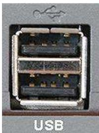
Universal Serial Bus (универсальная шина для передачи данных) все чаще встречается на разных моделях проекторов. Служит пока, главным образом, для осуществления управления проектором при помощи компьютера, и для управления компьютером с пульта дистанционного управления проектором. В дальнейшем не исключено использование этого порта и для передачи изображения и звука.
