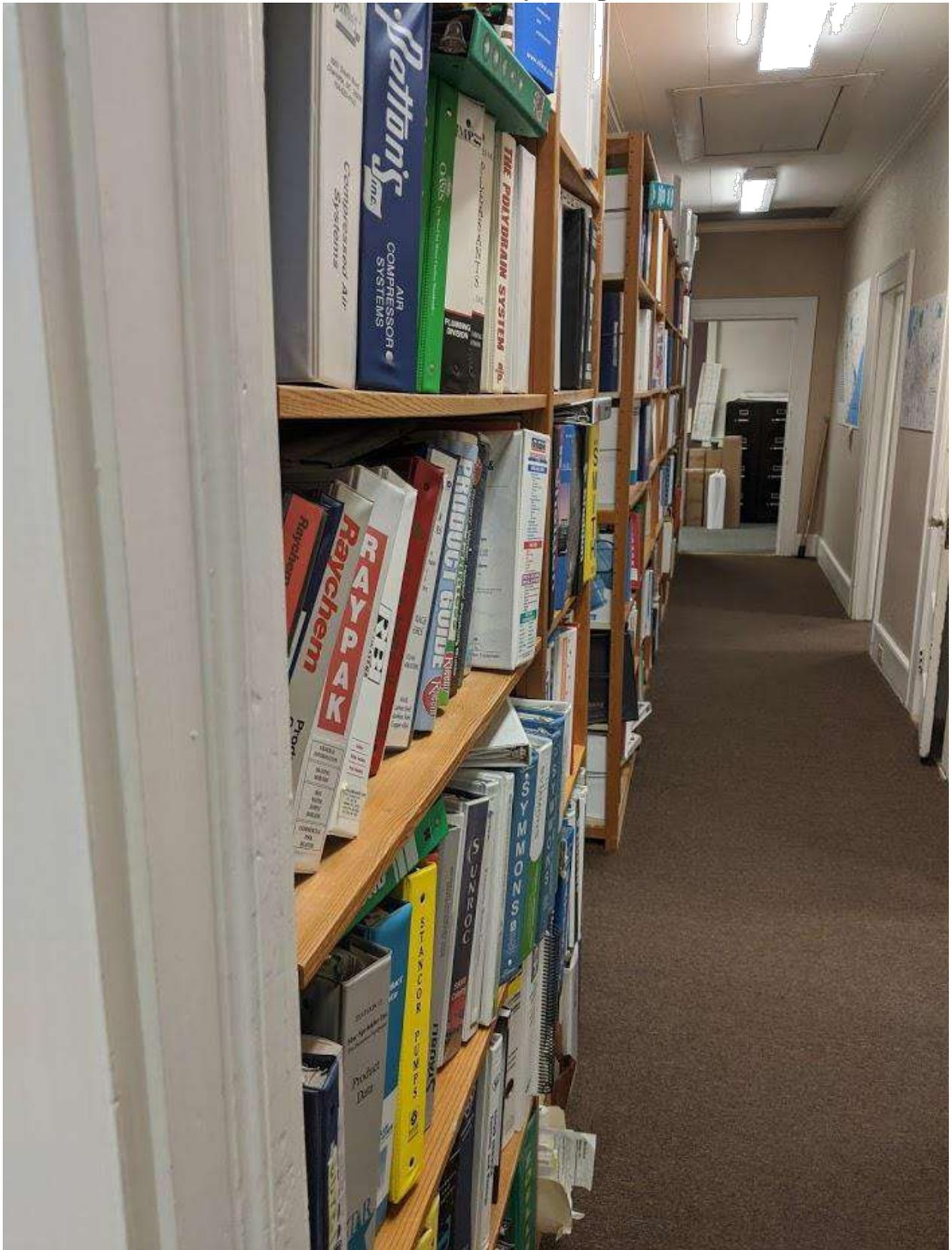
Плотно набитый книжный шкаф – серьёзное препятствие для радиоволн. Он стоит пары обычных стен даже при перпендикулярном проникновении. А уж в длину его пересекать вообще бесполезно.
