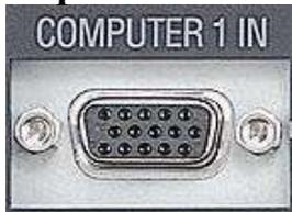
Служит для подключения компьютера. Это - наиболее распространенный способ присоединения компьютеров и мониторов к видео проектору. RGB-вход, чаще всего, имеет указательную
