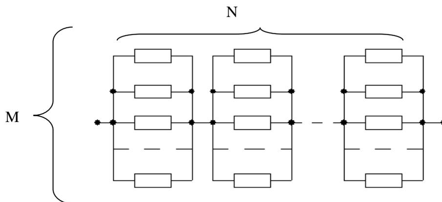
**Рисунок ПБ. 2 – Параллельно – последовательное соединение блоков**
