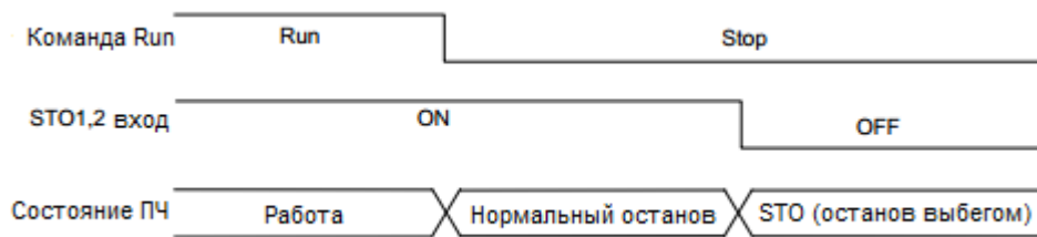
Рисунок 3 – Диаграмма работы функции STO во время останова ПЧ
