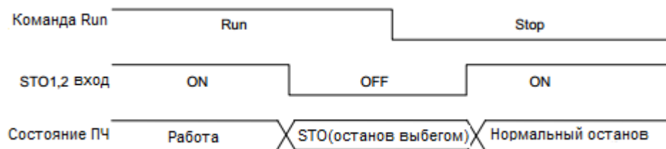
Рисунок 2 – Диаграмма работы функции STO во время работы ПЧ
