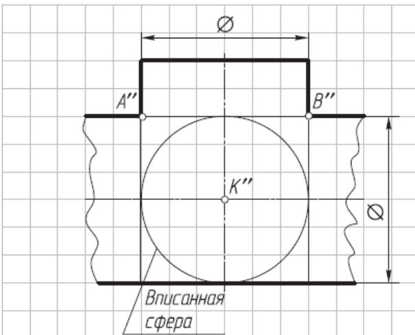
12. Достроить фронтальную проекцию шара с цилиндрическими отверстиями (3й и 4й частные случаи).
