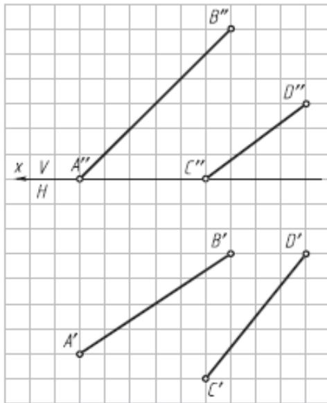
4. Определить углы наклона плоскости  $\alpha(\triangle ABC)$  к плоскостям проекций H и V (решать способом замены плоскостей проекций).
