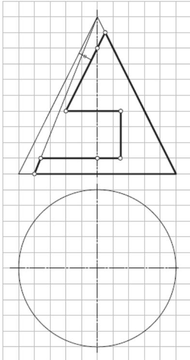
4. Достроить горизонтальную и построить профильную проекции полушара.
