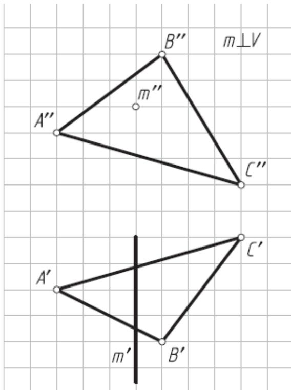
9. Определить проекции линии пересечения плоскостей  $\alpha$  ( $\alpha \perp V$ ) и  $\beta$  ( $\alpha \parallel \beta$ )
