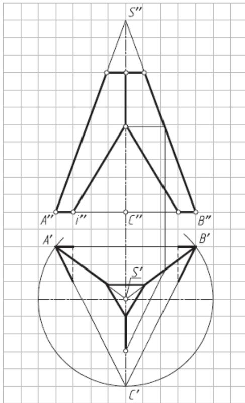
4. Построить половину развёртки боковой поверхности конуса со срезом (горизонтальную проекцию не достраивать).
