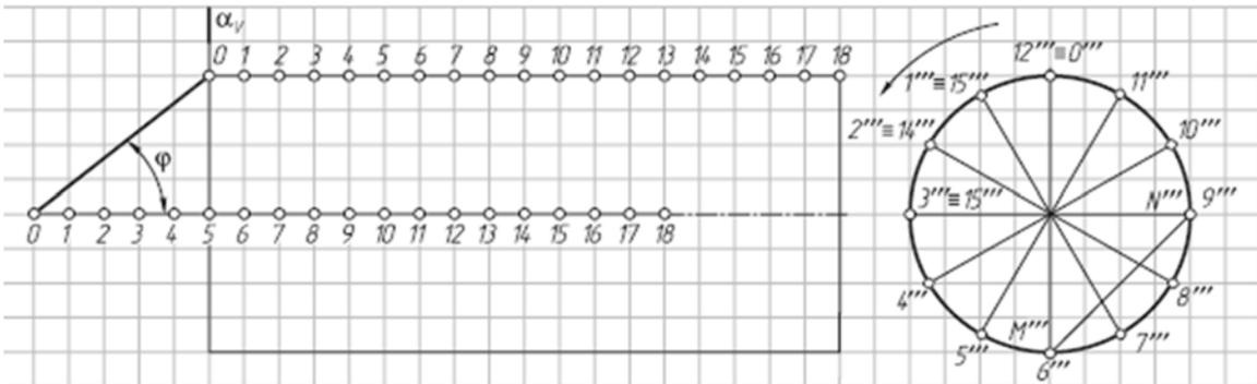
Построить на профильной проекции геликоида его сечение профильной плоскостью  $\alpha$  ( $\alpha_v$ ). Построить фронтальную проекцию линии MN, лежащей на поверхности геликоида.
