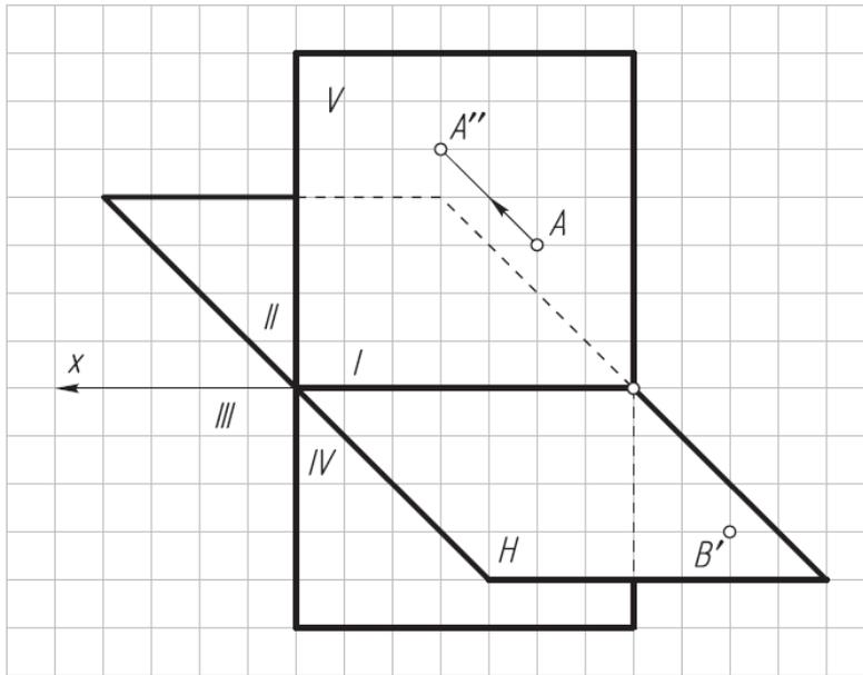
2. Определить по чертежу, в каких четвертях пространства находятся точки А, В, С и D и каким плоскостям проекций принадлежат точки Е и F.
