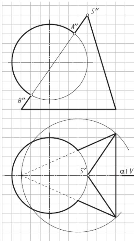
17. Построить фронтальную и горизонтальную проекции линии пересечения поверхностей геометрических тел и оформить очерки проекций (применить способ вспомогательных секущих плоскостей).
