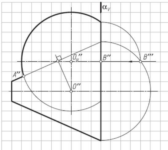
22. Построить фронтальную проекцию линии пересечения эллиптического цилиндра с круговым конусом и оформить очерк проекции (применить способ эксцентрических сфер).
