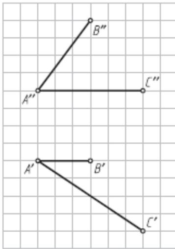
15. Построить плоскость, параллельную заданной плоскости  $\alpha$  (ABC) и отстоящую от нее на расстояние 20 мм (рис. 3.15) (1й тип задач).
