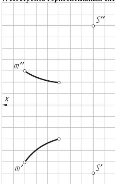
8. Построить фронтальную проекцию линии сечения эллиптического цилиндра горизонтально-проецирующей плоскостью  $\alpha_H$
