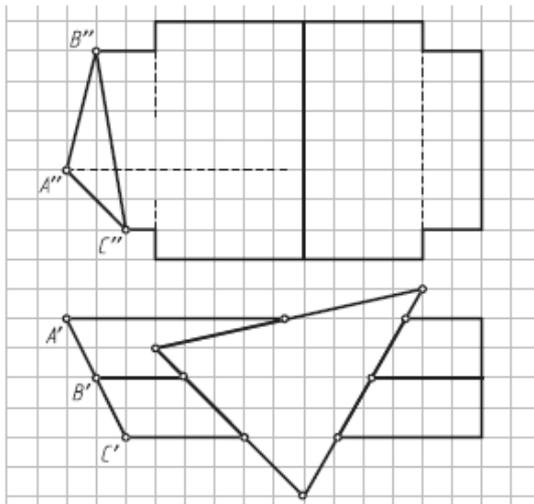
9. Построить горизонтальную проекцию линии пересечения поверхностей двух геометрических тел (одностороннее касание—2й частный случай).
