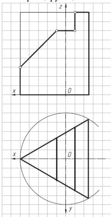
2. Построить прямоугольную изометрическую проекцию цилиндра со срезами фронтально-проецирующими плоскостями.
