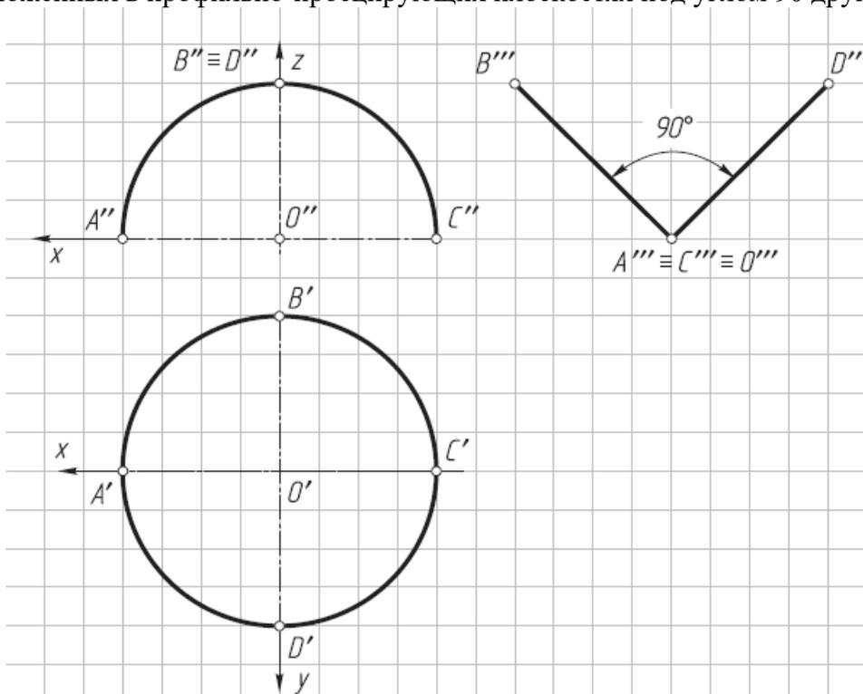
5. Достроить горизонтальную проекцию конуса и построить его прямоугольную изометрию.
