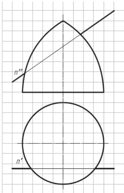
4. Найти точки пересечения прямой  $m$  общего положения с линейчатой поверхностью наклонного конуса, используя сечение поверхности конуса вдоль образующих плоскостью общего положения.
