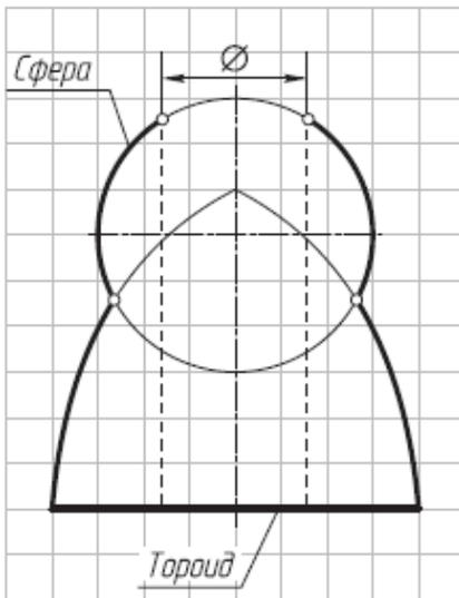
11. Построить фронтальную проекцию линии пересечения цилиндров, описанных вокруг сферы (рис. 11.11) (4й частный случай; применить теорему Г. Монжа).
