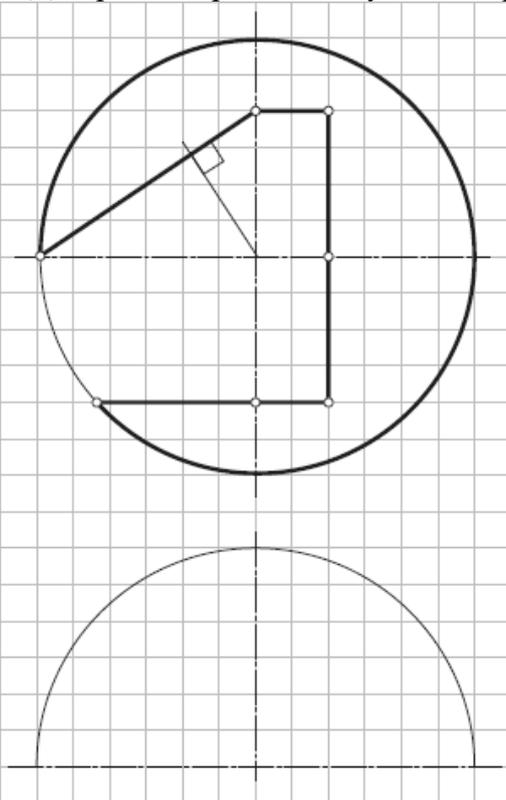
5. Достроить профильную и построить горизонтальную проекции конуса.
