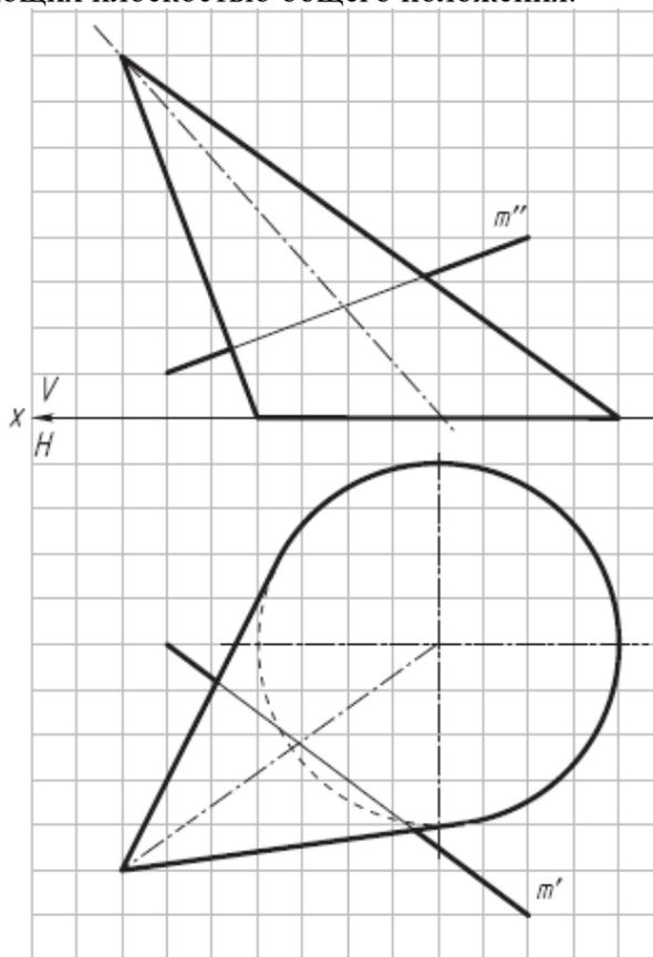
5. Найти точки пересечения прямой  $n$  общего положения с линейчатой поверхностью наклонного цилиндра, используя сечение поверхности цилиндра вдоль образующих плоскостью общего положения.
