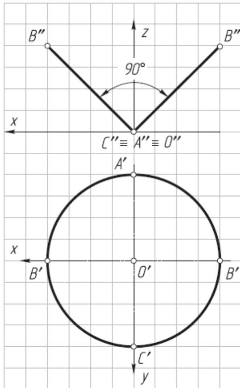
4. Построить прямоугольную изометрическую проекцию двух полуокружностей, расположенных в профильно-проецирующих плоскостях под углом  $90$  друг к другу.
