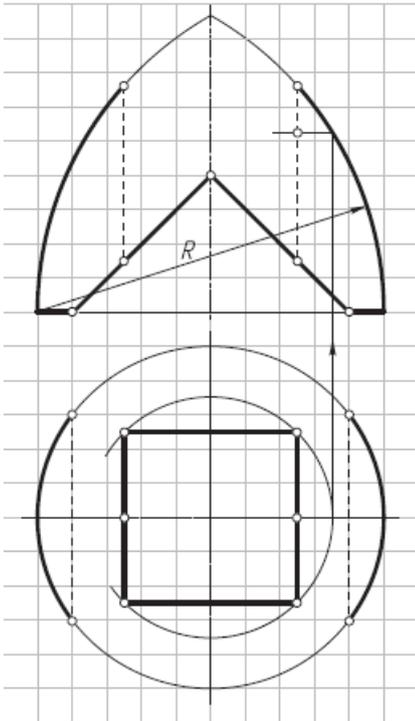
12. Построить фронтальный и профильный очерки поверхности однополостного гиперболоида вращением прямой АВ вокруг оси  $i$  ( $i \perp W$ ).
