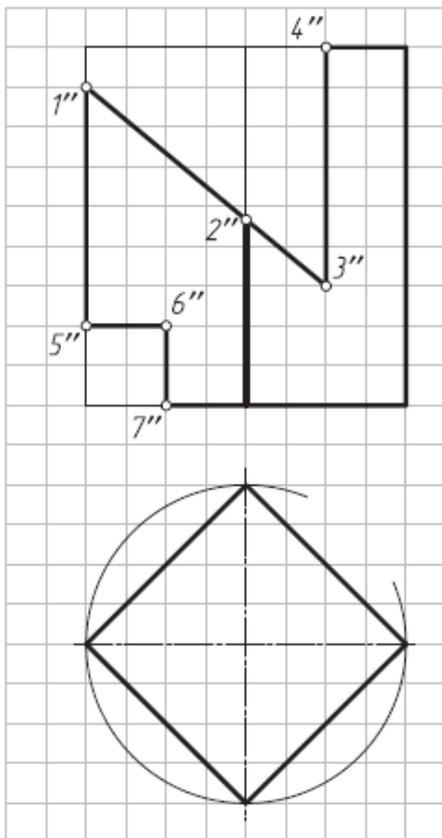
2. Достроить горизонтальную и построить профильную проекции пирамиды.
