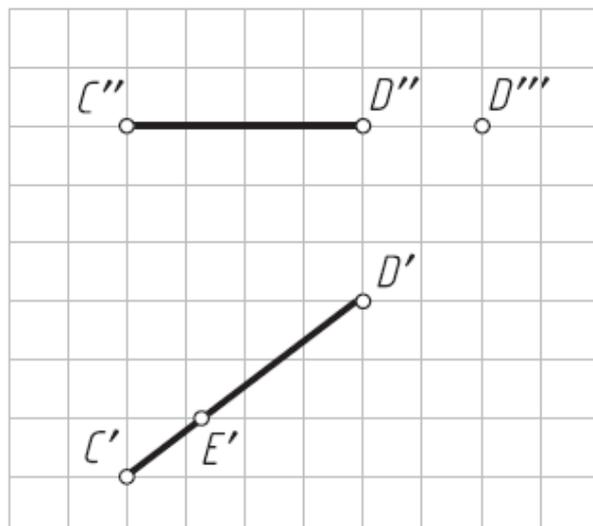
3. Достроить горизонтальную проекцию отрезка EF, параллельного плоскости V и расположенного от нее на расстоянии 15 мм.
