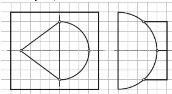
4. Дорисовать горизонтальную и построить профильную проекции комбинированного геометрического тела (пересечение трех поверхностей, 1й частный случай).
