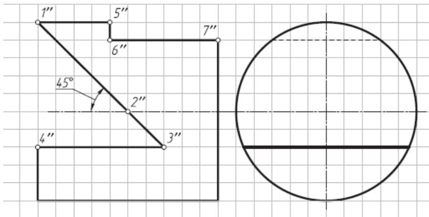
3. Достроить горизонтальную и построить профильную проекции конуса (рис. 7.3).
