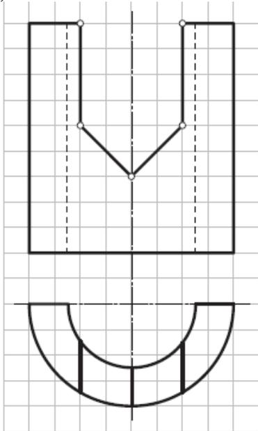
3. Построить горизонтальную проекцию комбинированного геометрического тела (1й частный случай).
