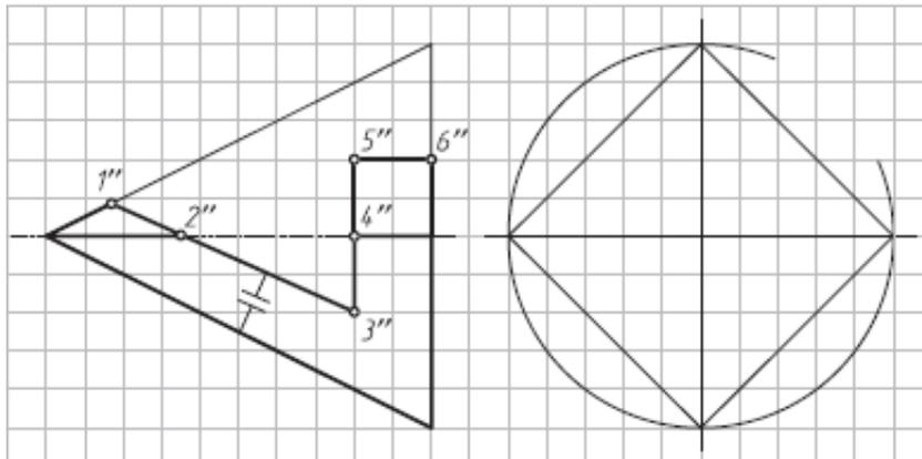
6. Построить горизонтальную проекцию ломаной линии 1–2–3, лежащей на боковой поверхности неправильной пирамиды.
