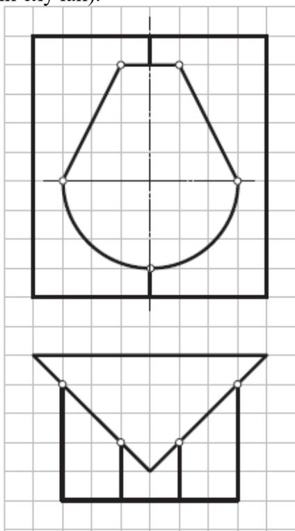
2. Построить профильную проекцию полого полуцилиндра с вырезом (1й частный случай).
