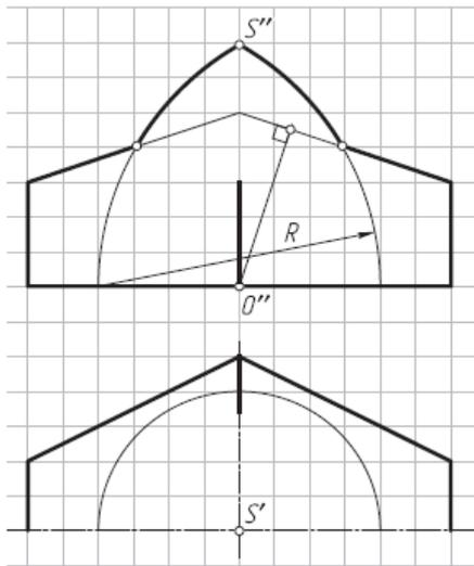
21. Построить фронтальную проекцию линии пересечения поверхностей геометрических тел и оформить очерк проекции (применить способ концентрических сфер).
