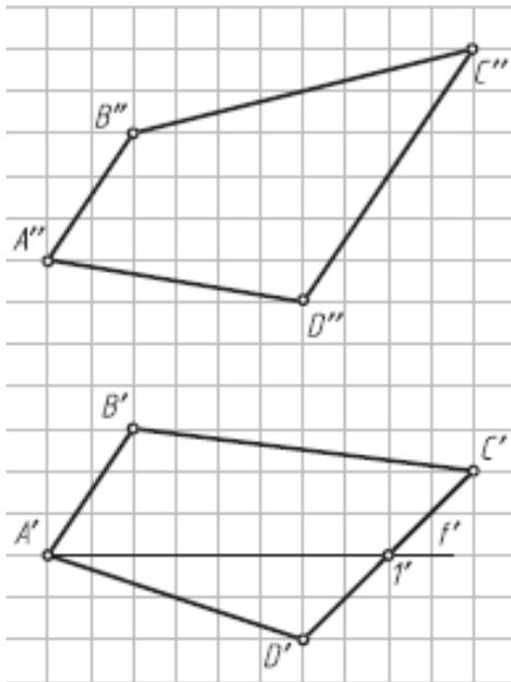
9. Определить натуральную величину угла между прямой АВ и плоскостью  $\alpha$  ( $m \parallel n$ ) (использовать точку А прямой АВ; вращать вокруг фронтали).
