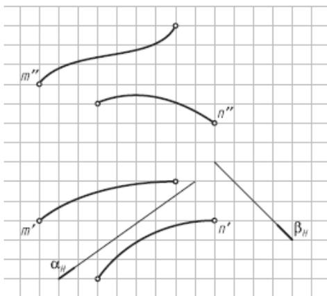
6. Построить горизонтальную проекцию линии n, лежащей на поверхности коноида  $\phi$  ( $a, b, \beta$ ) [A].
