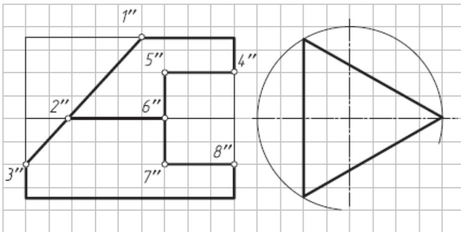
4. Построить горизонтальную проекцию ломаной линии 1–2–3–4–5, лежащей на боковой поверхности наклонной неправильной призмы.
