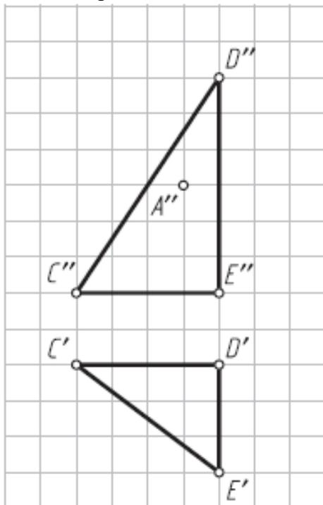
6. Построить проекции плоскости  $\beta$ , параллельной заданной плоскости  $\alpha$  ( $m \parallel n$ ) и проходящей через точку  $A$  (использовать фронталь плоскости как вспомогательную прямую).
