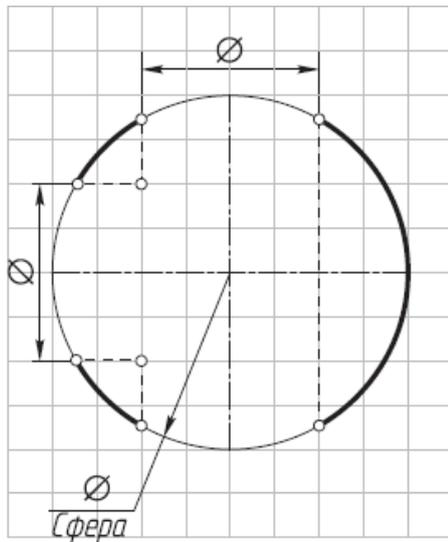
13. Построить фронтальную проекцию линии пересечения цилиндра Ц и конуса К, описанных вокруг сферы. Определить точки двойного соприкосновения (4й частный случай; применить теорему Г. Монжа).
