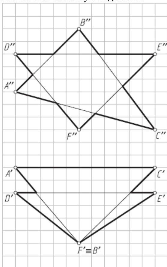
14. Построить проекции одного из шаров радиусом  $R = 10$  мм, центр которого расположен на расстоянии 25 мм от плоскости  $\alpha$  ( $AB \cap AC$ ) (1й тип задач — провести перпендикуляр от плоскости в пространство).
