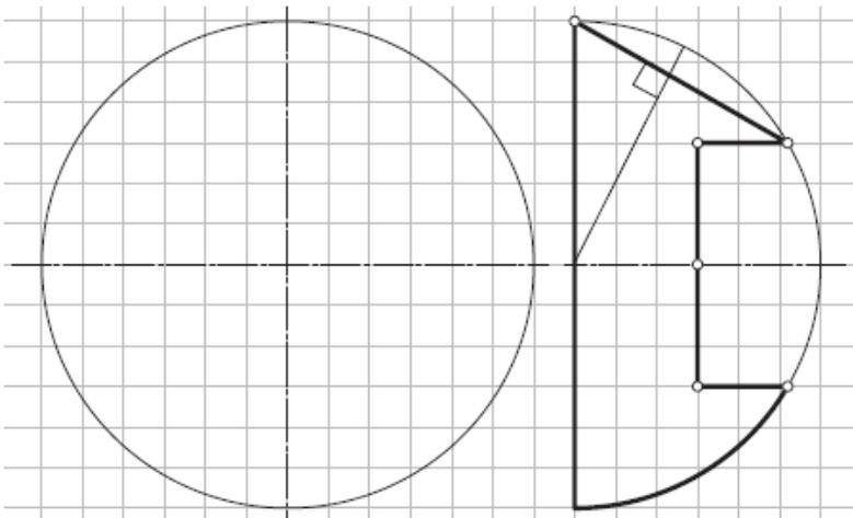
8. Достроить горизонтальную проекцию четверти открытого тора.
