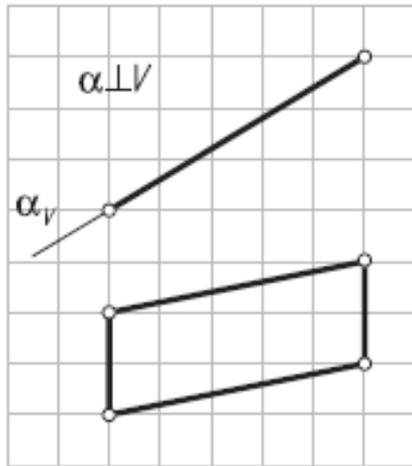
5. Построить горизонтальную проекцию точки  $A$ , лежащей в плоскости  $\alpha$  ( $\triangle CDE$ ) (использовать горизонталь плоскости как вспомогательную прямую).
