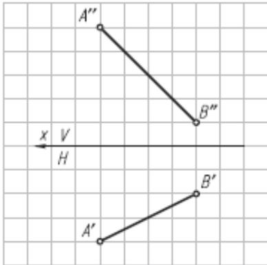
2. Определить радиус сферы с центром в точке О, касательной к прямой АВ (расстояние от точки до прямой) (решать способом замены плоскостей проекций).
