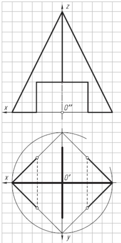
8. Построить косоугольную фронтальную диметрию цилиндра с прямоугольным пазом.
