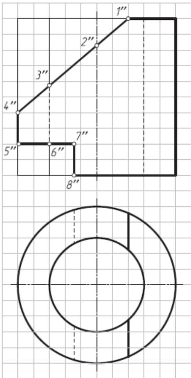
2. Построить горизонтальную проекцию цилиндра со срезами плоскостями частного положения.
