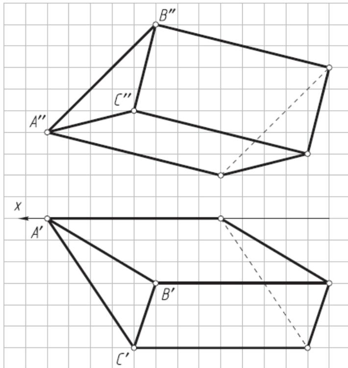
2. Построить развертку двухгранного угла САВ способом раскатки и проекции кратчайшего расстояния между точкой М, лежащей на грани АВ, и точкой N, лежащей на грани АС (геодезическую линию).
