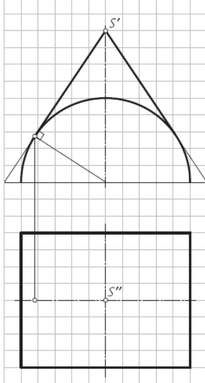
16. Построить фронтальную и горизонтальную проекции линий пересечения поверхностей геометрических тел и оформить очерки проекций (применить способ вспомогательных секущих плоскостей).
