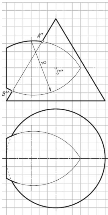
20. Построить фронтальную и горизонтальную проекции линии пересечения поверхностей геометрических тел и оформить очерки проекций (применить способ концентрических сфер).
