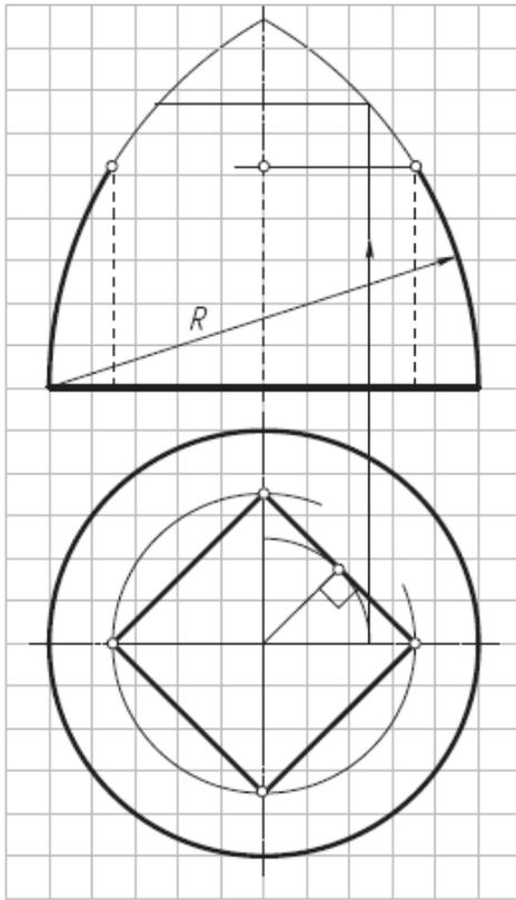
11. Достроить фронтальную и горизонтальную проекции тороида (самопересекающийся тор) с вырезом и призматическим отверстием.
