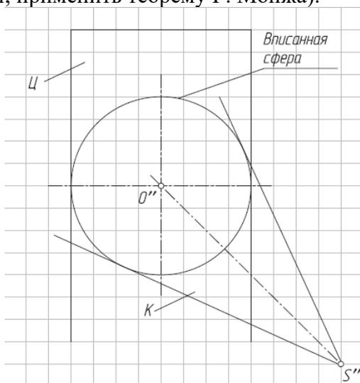
14. Построить фронтальную и горизонтальную проекции линии пересечения поверхностей геометрических тел, описанных вокруг сферы (двойное соприкосновение, 4й частный случай; применить теорему Г. Монжа).
