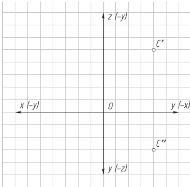
7. Построить проекции пространственной ломаной линии ABCDE, начиная с точки A, по координатам точек ее вершин: B (30, 30, 25), C (20, 5, 25), D (5, 15, 15), E (5, 25, 15).
