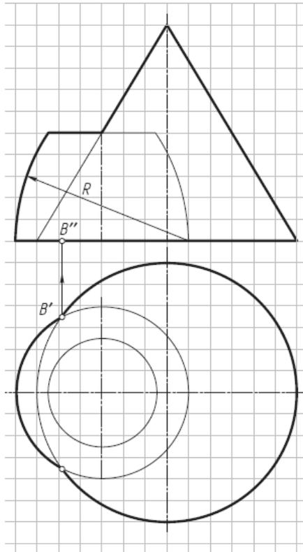
18. Построить фронтальную и горизонтальную проекции линии пересечения поверхностей тороида и конуса и оформить очерки проекций (применить способ вспомогательных секущих плоскостей или способ вращения вокруг проецирующей оси; для построения проекции верхней точки линии пересечения преобразовать чертеж).
