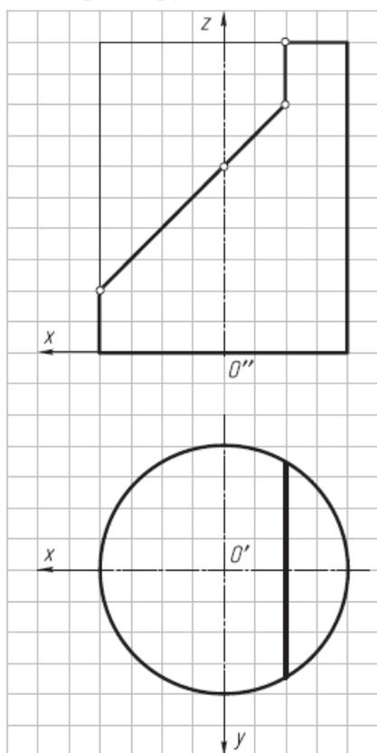
3. Построить прямоугольную изометрическую проекцию двух полуокружностей, расположенных во фронтально-проецирующих плоскостях под углом 90 друг к другу.
