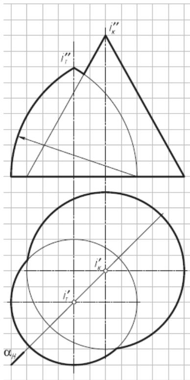
19. Построить фронтальную и горизонтальную проекции линии пересечения геометрических тел и оформить очерки проекций (применить способ концентрических сфер).
