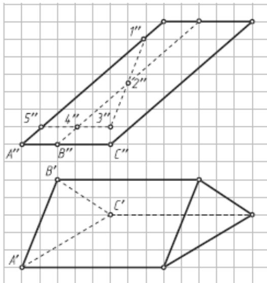
5. Достроить профильную и построить горизонтальную проекции пирамиды.
