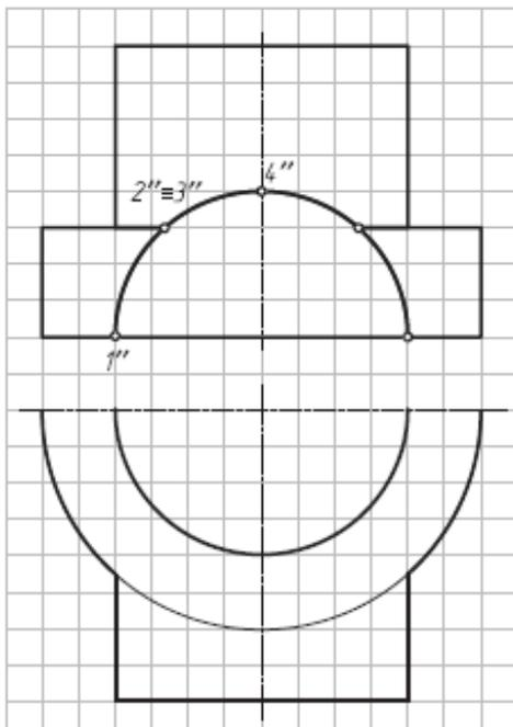
5. Дорисовать горизонтальную проекцию линии пересечения двух геометрических тел (2й частный случай).
