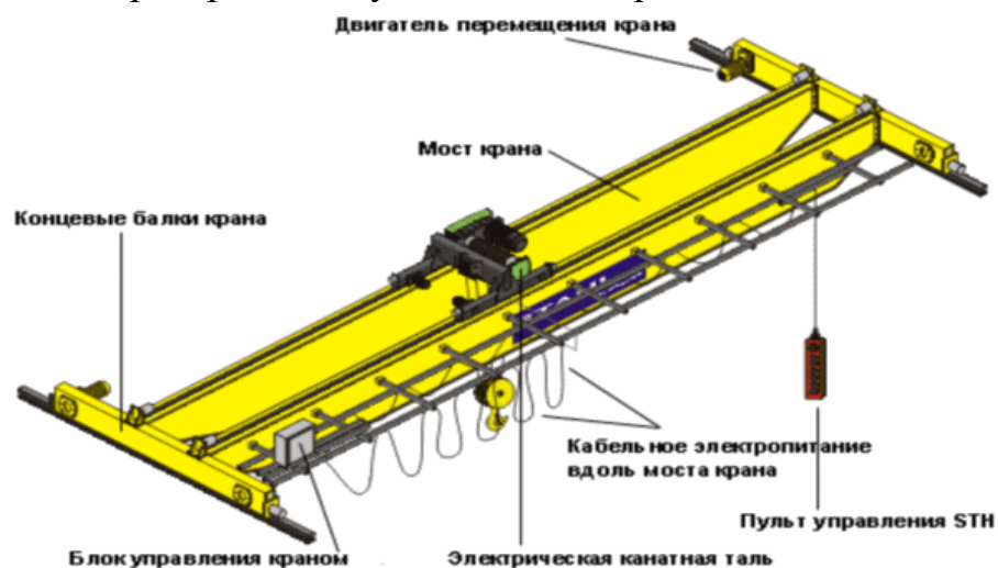
Рисунок 1 – Конструкция мостового крана грузоподъемностью 5 тонн Технические характеристики мостового крана прессово-волоочильного цеха: металлургический двухбалочный 5-ти тонный мостовой кран
