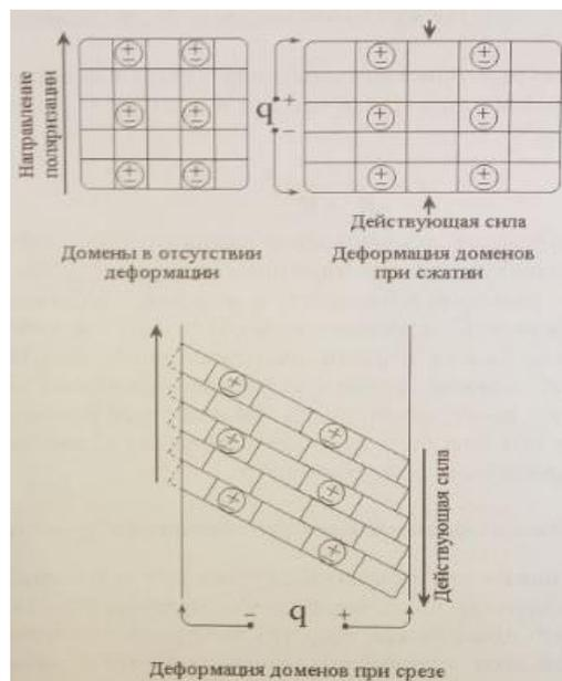
Рисунок 8 – Упрощенная модель пьезоэлектрического эффекта искусственно поляризованной керамики
