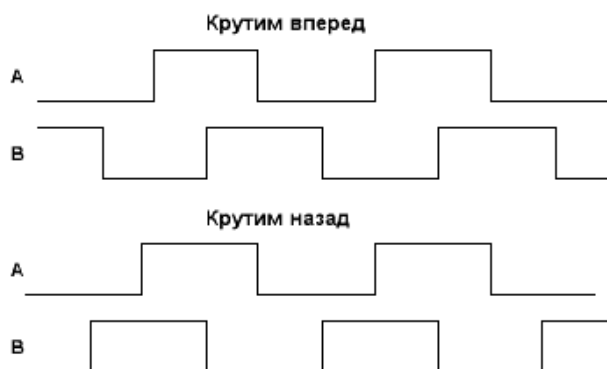
Рисунок 7 – Чередование выходных импульсов энкодера в зависимости от направления вращения.
