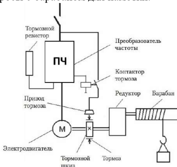
Рисунок 2 — Функциональная электромеханическая схема механизма главного подъема
