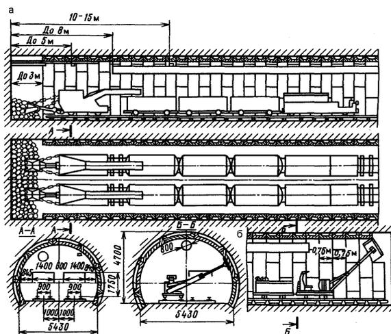
Рис. 1. Технологическая схема проведения двухпутевой выработки буровзрывным способом с применением двух бурильных установок, двух погрузочных машин и тюбинговой крепи
