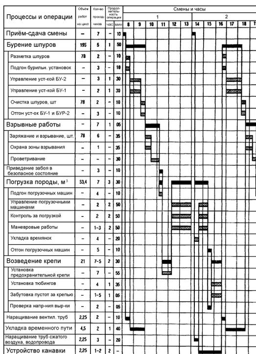
Рис. 2. График организации работ при проведении выработки буровзрывным способом
