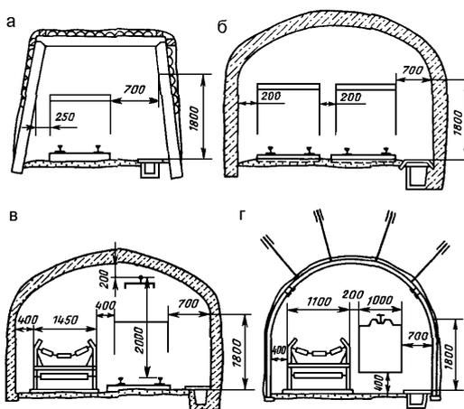
Рисунок 1 - Допустимые зазоры при выборе размеров поперечного сечения выработок: а – однопутевая; б – двухпутевая; в – однопутевая с ленточным конвейером; г – конвейерная с монорельсовым транспортом.
