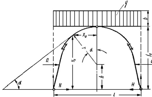
Рисунок 1 - Расчётная схема арочной податливой крепи
