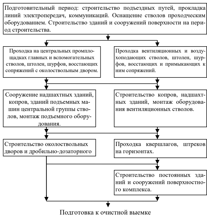
Рис. 6.1 Последовательность работ при строительстве рудника
