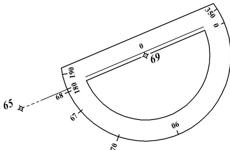
*Рис. 16. Ориентирование лимба транспортира по линии 69-65 при отсчетах по горизонтальному кругу теодолита, больших  $180^\circ$*
