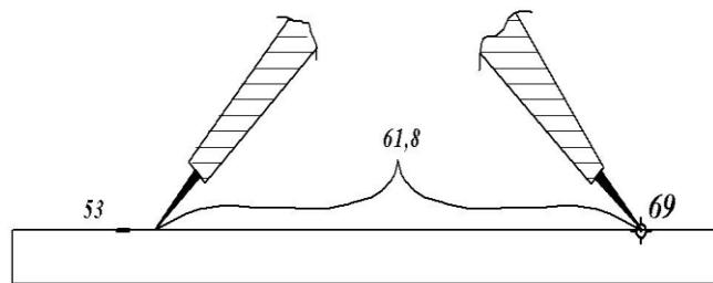
*Рис. 17. Определение линии "станция - съёмочный пикет"*
