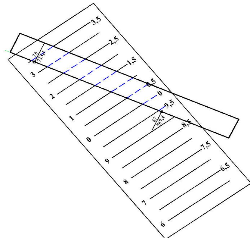
*Рис. 19. Интерполирование горизонталей с помощью палетки*
