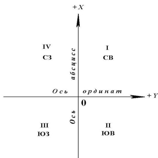
Рис. 4. Расположение осей координат и названия (номера) четвертей
