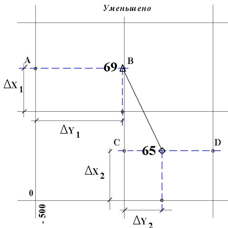
Рис. 7. Накладка на план вершин теодолитного хода
