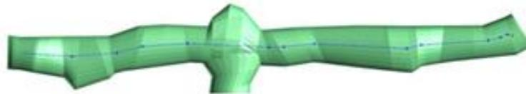
Осевая линия служит отсчетом для задания точки поворота стрелы бурового станка, при необходимости Вы можете поднять осевую линию на заданную высоту от почвы (высота стоянки бурового оборудования), используя функцию **Файл | Изменить данные | Вычисление | Вычислить**.
