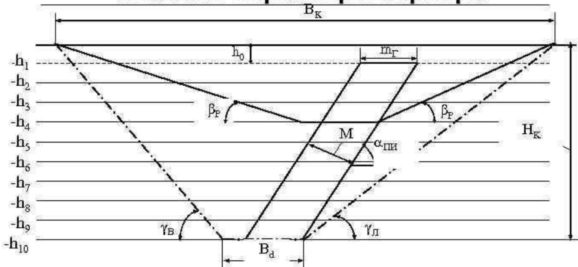
$B_k$ ,  $B_d$  – ширина карьерного поля по поверхности, по дну, м;
