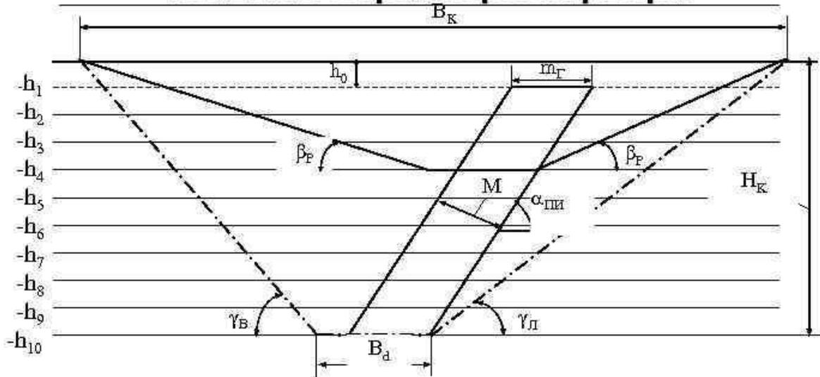
$B_K, B_d$  – ширина карьерного поля по поверхности, по дну, м;
