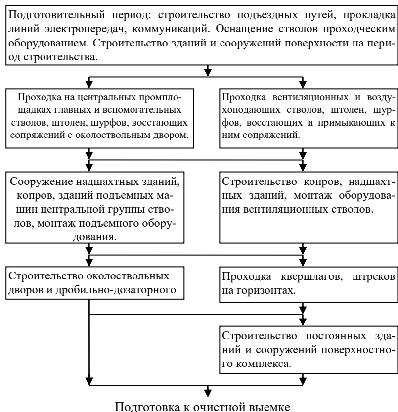
Рис. 6.1 Последовательность работ при строительстве рудника
