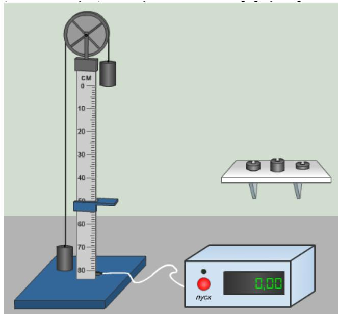
Через блок в форме диска радиусом 15 см и массой 40 г перекинута невесомая нерастяжимая нить, к концам которой подвешены грузы одинаковой массы (машина Атвуда). Если установить платформу на расстоянии 40 см, а к правому грузу добавить перегрузок № 1, то блок будет вращаться с угловым ускорением \_\_\_\_\_  $\text{рад}/\text{с}^2$ .
